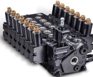
Unsere **DPX**-Ventil-Serie zeichnet sich durch die **nachgeschalteten Druckwaagen** (Flow-Sharing) aus. Dadurch wird gewährleistet, dass das zur Verfügung stehende Öl, je nach Verbraucher, entsprechend verteilt wird. Dies ermöglicht eine **lastunabhängige Steuerung** Ihrer Maschinenbewegungen.
