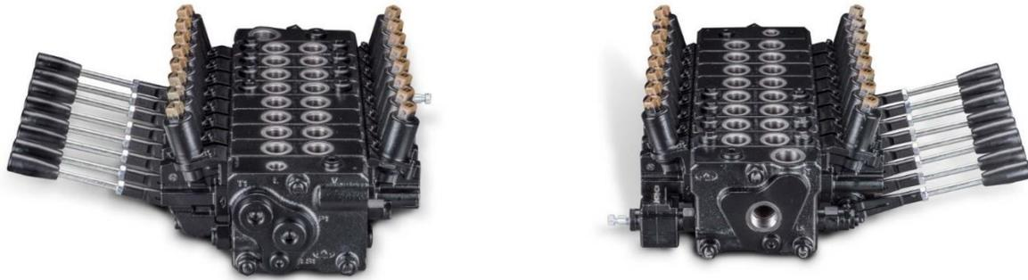
Unsere DPX-Ventil-Serie zeichnet sich durch die **nachgeschalteten Druckwaagen** (Flow-Sharing) aus. Dadurch wird gewährleistet, dass das zur Verfügung stehende Öl, je nach Verbraucher, entsprechend verteilt wird. Dies ermöglicht eine **lastunabhängige Steuerung** Ihrer Maschinenbewegungen.
